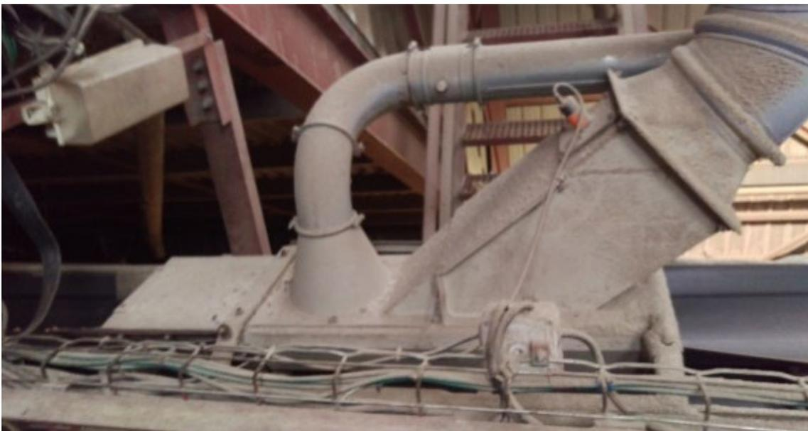
Figure 14 : Aspiration au niveau du dépôt des grains de maïs sur la bande
