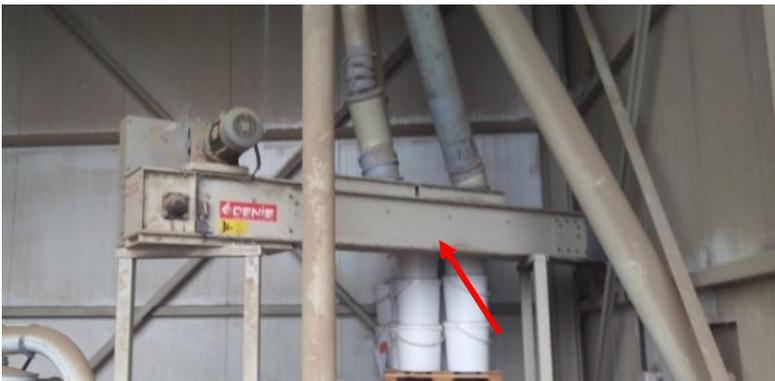
Figure 11 : Transporteur à chaîne utilisé pour acheminer les déchets
