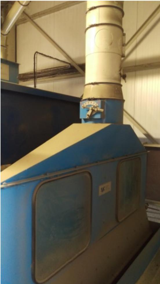
Figure 20 : Nettoyeur et aspiration
