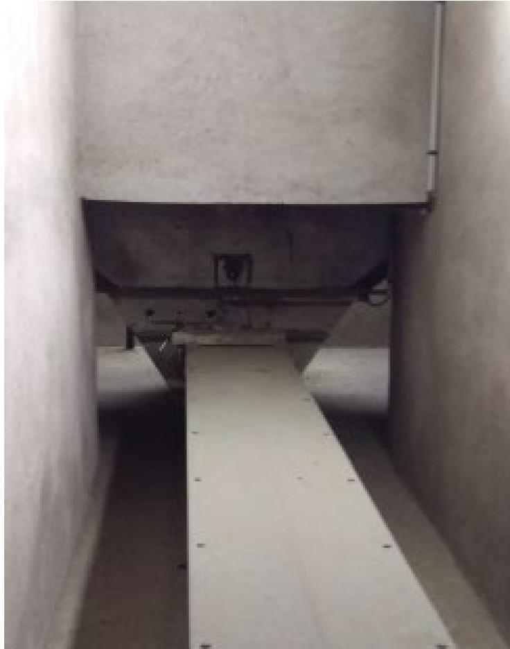
**Figure 18 : Boite de chute reliant un élévateur à un transporteur à chaîne**
