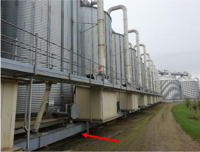
Figure 9 : Transporteur à chaîne pour vidange des silos extérieurs
