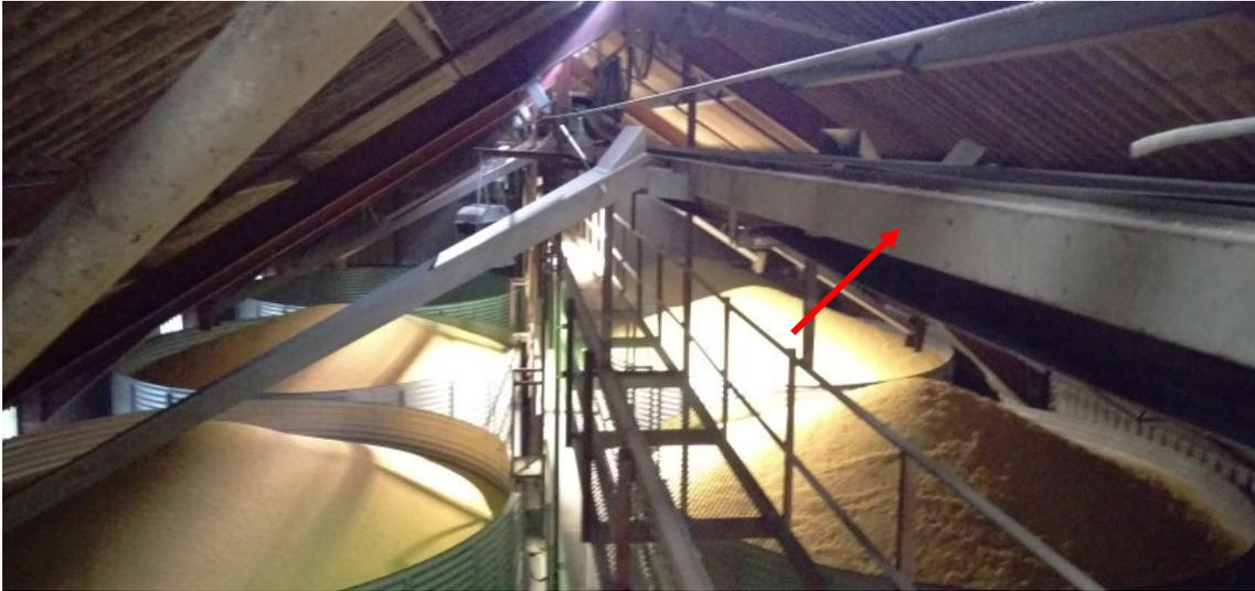
Figure 13 : Convoyeur à bandes alimentant les silos
